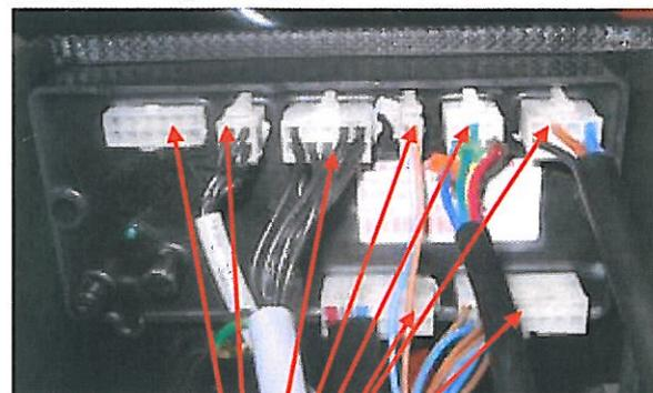
3. Die Kabelanschlüsse am Taster und am Joystick ebenfalls mit dem Spray gegen Korrosion schützen.
